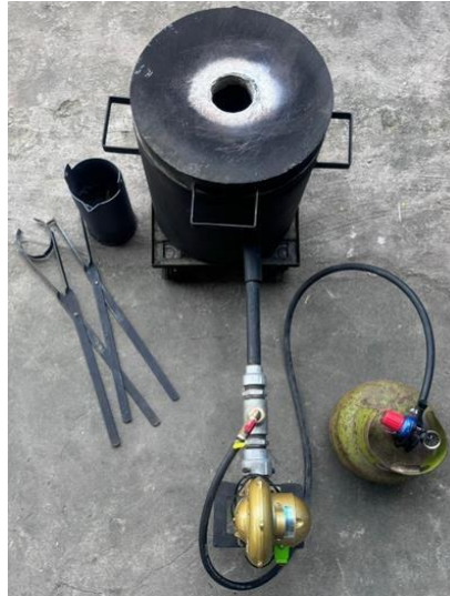
Gambar 2. Tungku krusibel untuk peleburan logam bukan besi kapasitas 5 kg dengan bahan bakar gas
