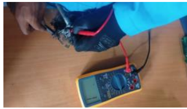
Gambar 15. Pengukuran Brush Holder
