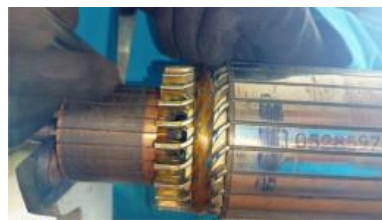
Gambar 14. Pengukuran Isolasi Armature
