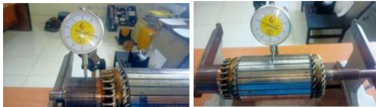
Gambar 11. Pengujian Run Out
