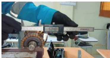
Gambar 12. Pengukuran Diameter Luar Sisi Luar Komutator
