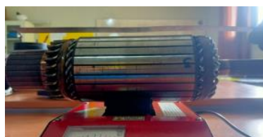
Gambar 9. Pengujian Medan Magnet Armature
