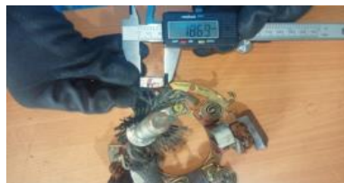
Gambar 13. Pengukuran Panjang Brush
