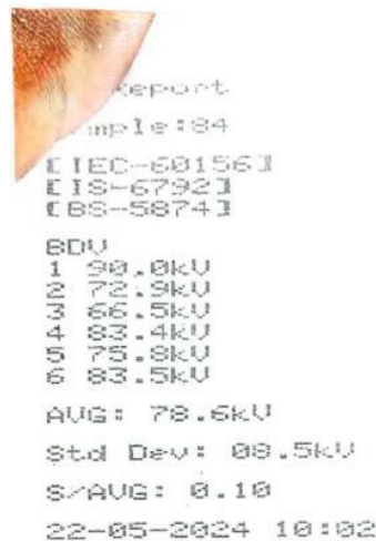
Gambar 7. Hasil Percobaan Pengujian Minyak Trafo Setelah Purifikasi
