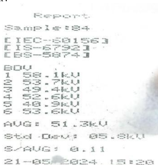
Gambar 6. Hasil Percobaan Pengujian Minyak Trafo Sebelum Purifikasi
