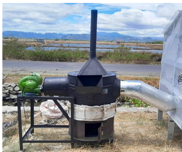
Gambar 2. Hasil perancangan alat tungku bioassay tipe heat exchanger
