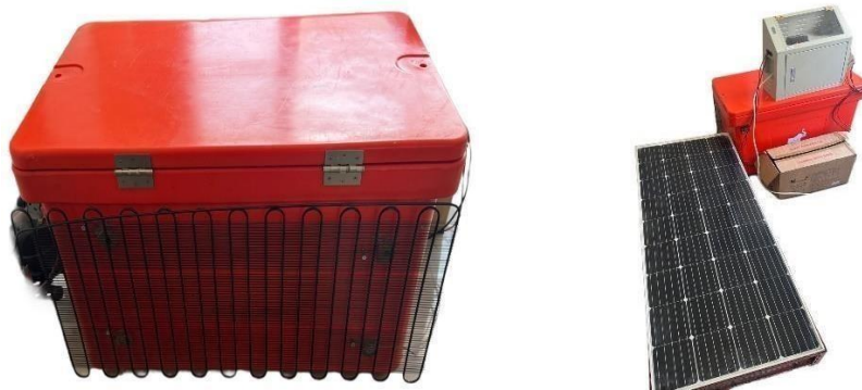
Gambar 1. Hasil rancang bangun box pendingin ikan menggunakan PLTS
