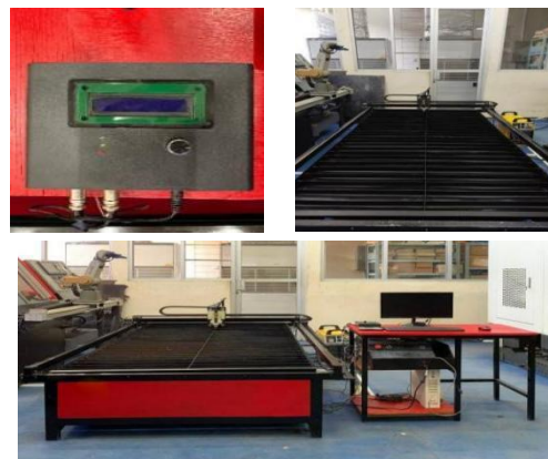
Gambar 2. THC, Meja Plasma, dan Keseluruhan Hasil Pengembangan Mesin CNC Plasma Cutting
