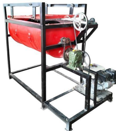
Gambar 3. Mesin Pengayak dan Pencampur Bahan Media Tanam Jamur Tiram
