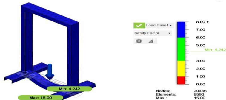
Gambar 4 Simulasi Safety Factor Pada Rangka Kritis
