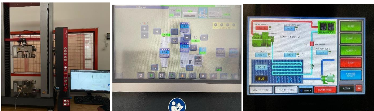
Gambar 2. Alat quality control, monitor chiller &amp; extruder untuk data suhu dan melihat parameter hasil produk
