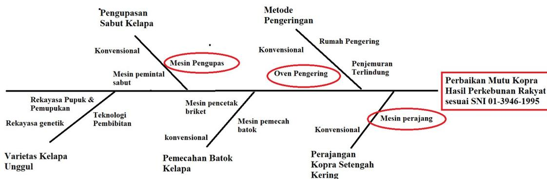
Gambar 2: Fishbone diagram untuk perbaikan mutu kopra hasil perkebunan rakyat
