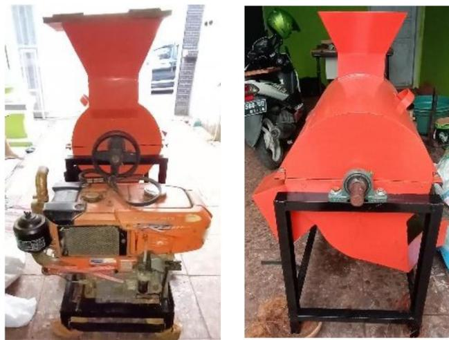
Gambar 3. Mesin Pengurai serat sabuk kelapa
