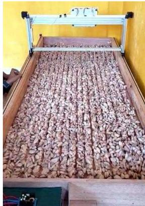
Gambar 3. Pengambilan data Solar Dryer
