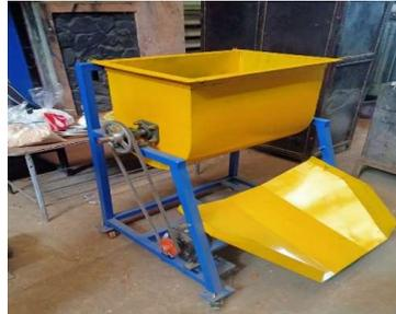
Gambar 2. Mesin pencampur bahan media tanam jamur Tiram
