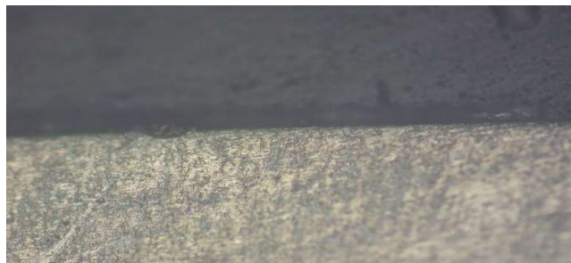
Gambar 4. Permukaan logam sebelum ditambahkan inhibitor perbesaran 200x
