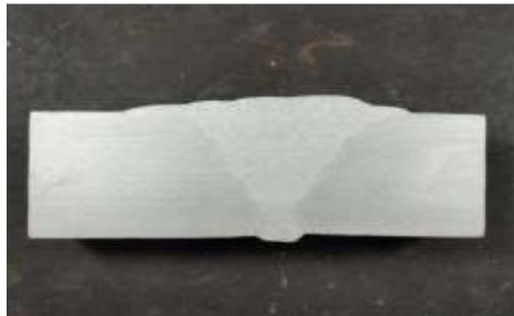
Gambar 9: Spesimen *Hardness Vickers Test*
