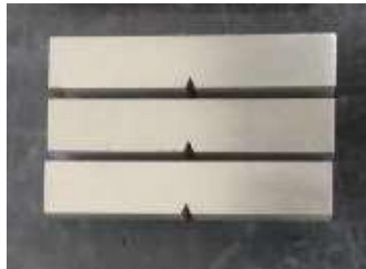
Gambar 7: Spesimen Charpy V-Notch
