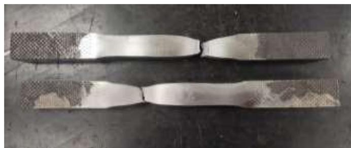
Gambar 10: Spesimen *Tensile Test*
