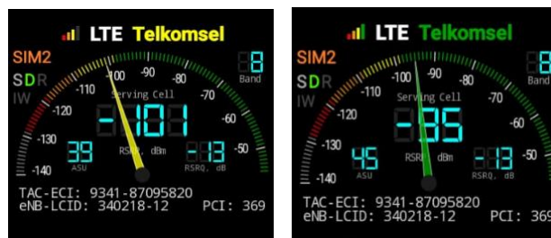
Gambar 6. Nilai RSRP pada aplikasi NCIL, (kiri) sebelum dan (kanan) setelah diterapkan antenna pasif.
