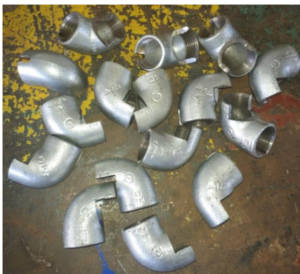
Gambar 1. Sudu turbin dari pipa elbow sudut 90°
