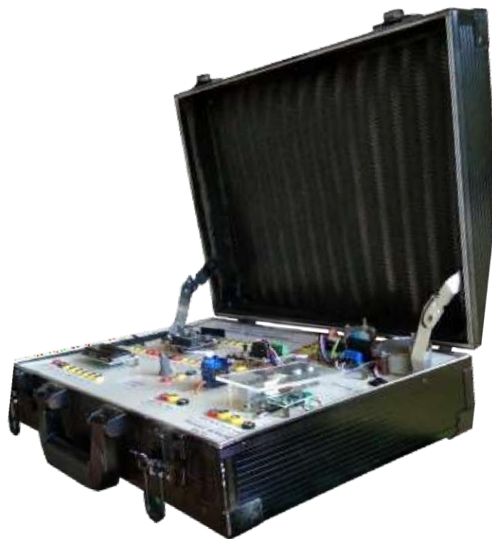
Gambar 5. Hasil pengembangan trainer mikrokontroler secara keseluruhan
