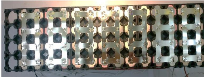
Gambar 6. Hasil rangkaian slas titik/*spotting*
