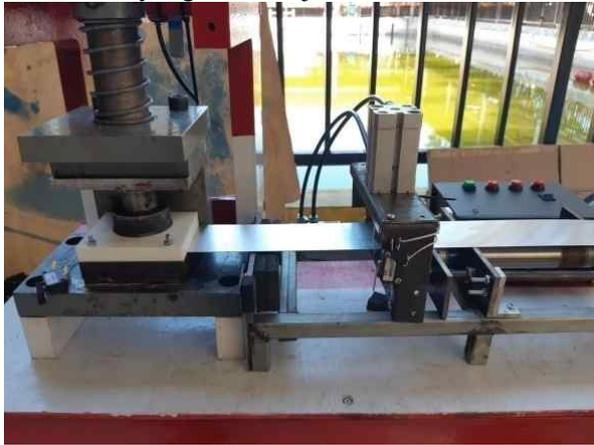
Gambar 14. Penempatan Pelat Pada *Press Tool*
