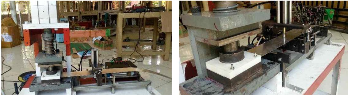
Gambar 12. Alat *Automatic Press Tool* Untuk *Blanking* Cetakan Kue
