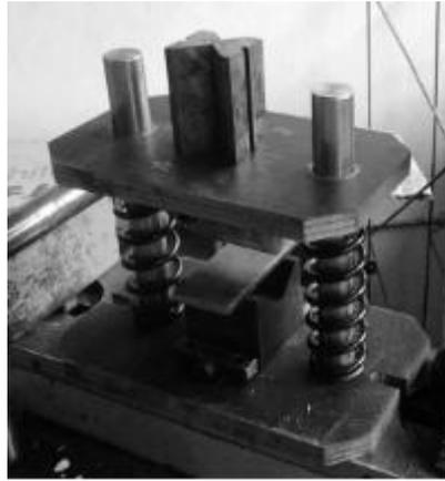
Gambar 14. *Press tool* untuk *bending V bottoming*
