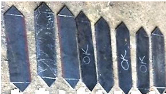
Gambar 6. Bahan sirip roda traktor siap dibentuk pada alat *metal forming*
