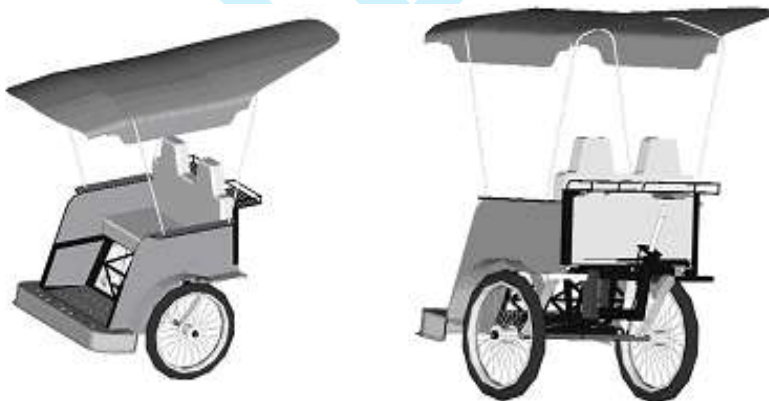
Gambar 1. Desain Konstruksi Dari Samping Tipe Dorong Kendaraan Bentor Yang Ada Sekarang ( Existing )
