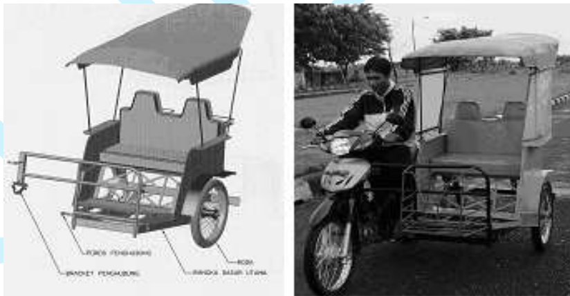
Gambar 3. Lay Out Konstruksi Bentor Tipe Gandengan/Tipe tempelan dan uji coba operasional bentor di jalan/lapangan uji
