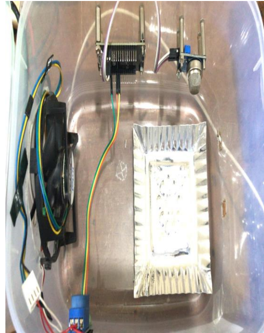
Gambar 2. Sistem Pendeteksi Asap Rokok Dalam Ruangan.
