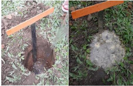
Gambar 10. Pengisian lubang dengan air
