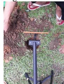
Gambar 9. Penempatan posisi alat pada tengah lubang
