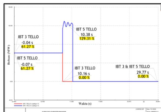
Gambar 5 Kurva Kemampuan Pembebanan Peralatan (%) IBT GI Tello Setelah IBT #3 GI Tello Trip Sebelum Implementasi OLS
