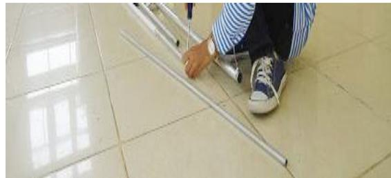
Gambar 8. Penyambungan Elemen-elemen pada Antena.
