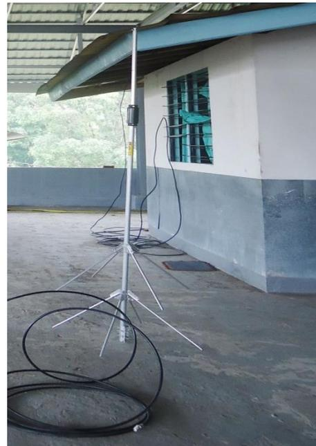
Gambar 12. Bentuk Antena Vertical  $\frac{5}{8} \lambda$ .
