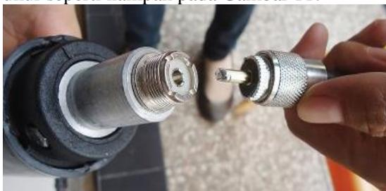
Gambar 11. Pemasangan Kabel Koaksial ke Loading Impedansi.
