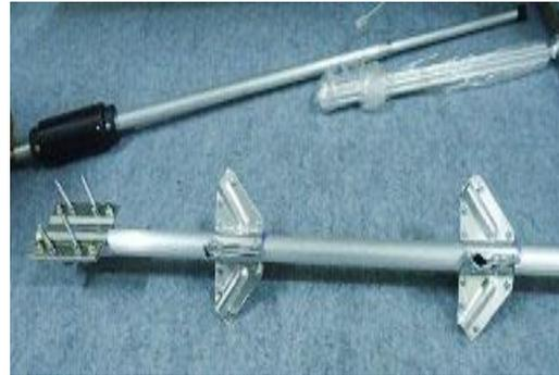
Gambar 7. Clamps Radial Antena yang Telah Dipasang.
