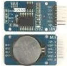
Gambar 2 DS3231 RTC Module
