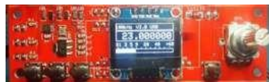
Gambar 12. Realisasi VFO DDS menggunakan Si5351 terkendali Arduino.
