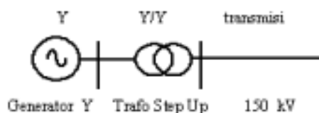
Gambar 3. Sistem Transmisi 150 kV/20 kV ( http://distribusitenaga.blogspot.co.id/2013/11/01/archive.html , diakses pada tanggal 11 maret 2016)
