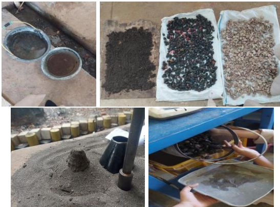
Gambar 5. Pengujian Berat Jenis Agregat dan Penyerapan Agregat
