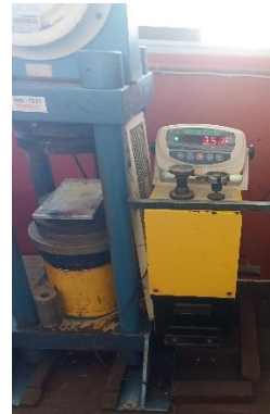
Gambar 11. Alat Pengujian Kuat Tekan Beton
