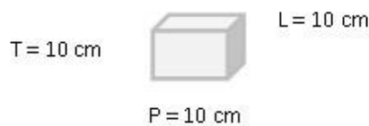
Gambar 5. Ukuran Sampel untuk Uji Kuat Tekan
