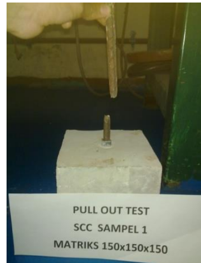
Gambar 7. Kegagalan Putus Benda Uji Pull Out Beton SCC
