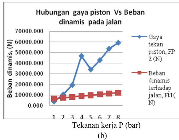
Gambar 5 (a) Karakteristik beban dinamis oleh gaya piston, F_{p2} terhadap pegas dan shock absorber. (b) Hubungan antara gaya piston F_{p2} dan beban dinamis F_{t1} yang membebani struktur jalan.
