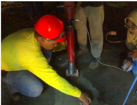
Gambar. 10. Pengambilan sampel beton inti
