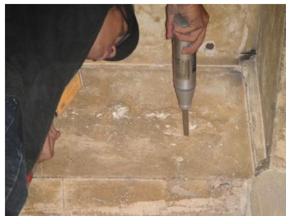
Gambar. 9. Pengujian alat palu beton tipe N
