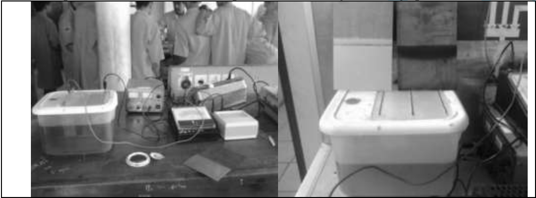
Gambar 3. Perbedaan warna limbah cair, sebelum dan sesudah di elektrolisis pada pengujian pasangan tunggal elektroda.
