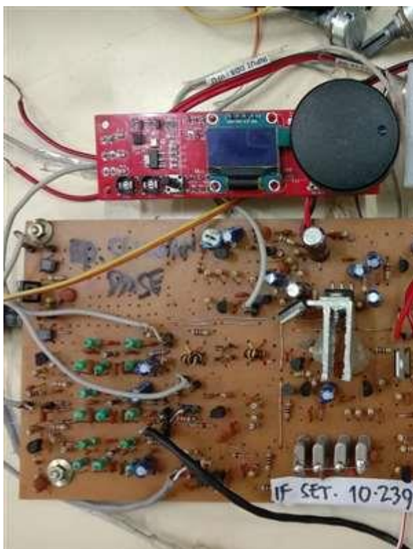
Gambar 14. Realisasi radio pemancar-penerima SSB.
