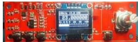
Gambar 12. Realisasi VFO DDS menggunakan Si5351 terkendali Arduino.
