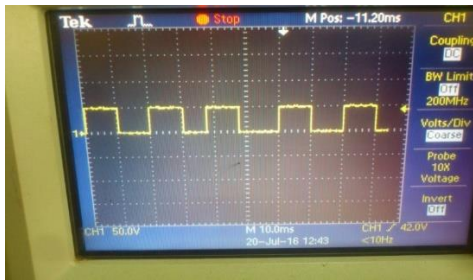
Gambar 9. Pengujian PWM di Mikrokontroller
